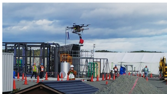
ロボットアームにターニケットを入れた救急袋をぶらさげて被災者に届けるドローン
